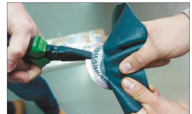
Рис. 2.3.4 Когезионный разрыв между полимерной мембраной и тарелкой с полимерным покрытием
