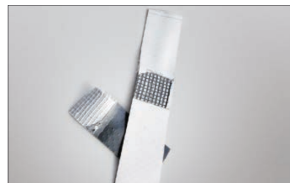
Рис. 5.2.10 Вырезание тестовой полоски из сварного шва
