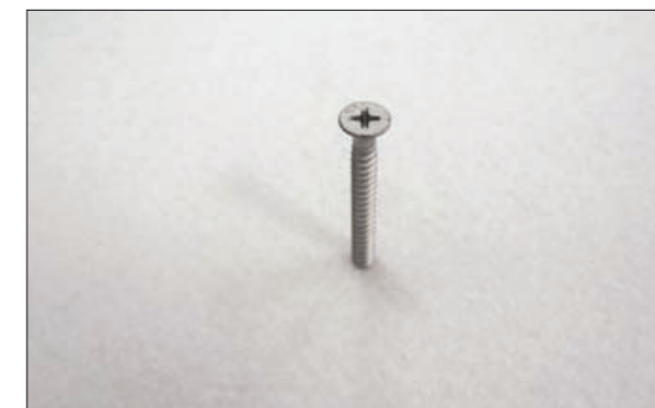
Рис. 3.3.2 а Засверливание самореза в термообработанный геотекстиль
