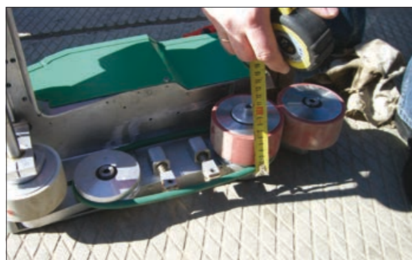
Рис. 3.5.5 Ширина рабочей поверхности Leister Varimat, равная 60 мм
