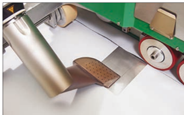
Рис. 5.2.6 Сварка с использованием металлической пластинки
