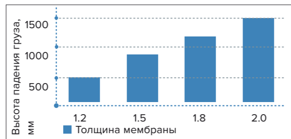
Рис. 4.3.2 Зависимость показателя ударной прочности от толщины мембраны
