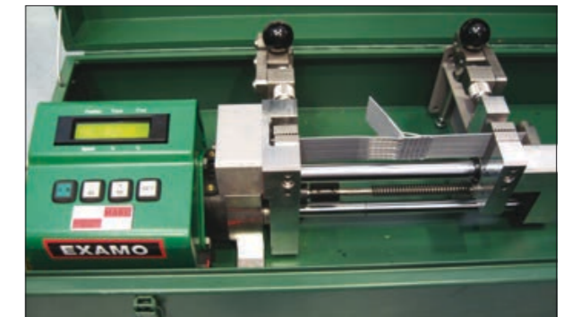
Рис. 5.2.5 Проверка качества сварного шва при помощи Leister Examo
